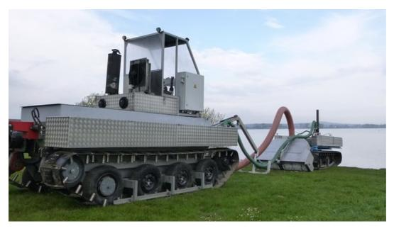
Der Bagger hatte die rund einen Meter dicken Sedimentsablagerungen gelockert und über eine Pumpe abgesaugt. Diese Technik ist laut Wasserwirtschaftsamt vor allem für hohe Sedimentsablagerungen wie etwa im Auslaufbereich des Sees gut geeignet. Weil der Altmühlsee überwiegend geringe Auflagen von etwa 30 Zentimetern hat, sucht das Amt nun nach Alternativen.
